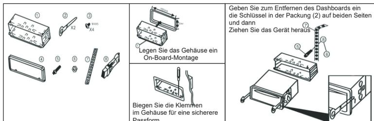
1. Führen Sie das Gehäuse in Bord ein.
