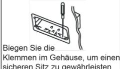
Biegen Sie die Klemmen im Gehäuse, um einen sicheren Sitz zu gewährleisten
