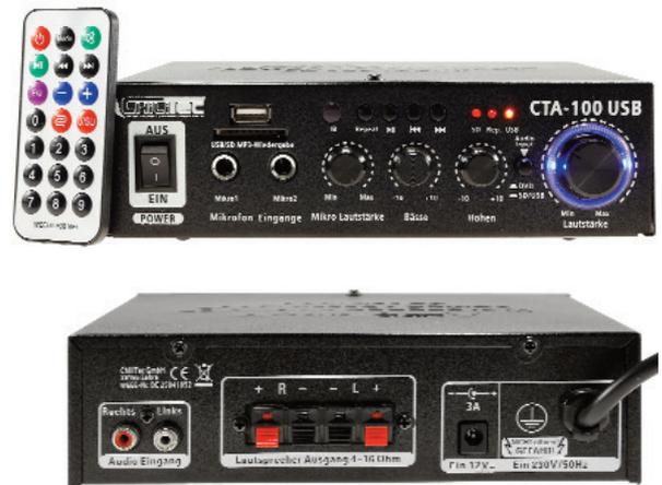
**ACHTUNG WICHTIGER HINWEIS: Die Bedienung des Gerätes mit der Fernbedienung funktioniert ausschließlich bei der Wiedergabe von MP3 Dateien im Modus SD oder USB! Eine Lautstärke oder Klangveränderung mit der Fernbedienung ist NICHT möglich bei Wiedergabe über die externen Eingänge (Cinch & Mikro & Bluetooth).**
