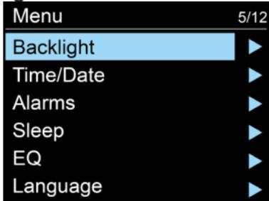
Selectionnez le niveau lumineux du rétroéclairage (Élevé/Moyen/Faible) et la durée de temporisation (Toujours allumé/10/20/30/45/60/90/120/180 s). Quand une temporisation est sélectionnée, le rétroéclairage s'affaiblit automatiquement si l'appareil n'est pas utilisé pendant la durée définie.
