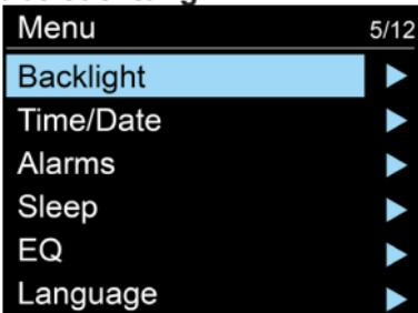
Wählt die Leuchtintensität der Hintergrundbeleuchtung (Hoch/Niedrig/Aus) und den Abschaltzeitpunkt (**Immer An/10/20/30/45/60/90/120/180 s**) aus. Wurde ein Abschaltzeitpunkt eingestellt, wird die Hintergrundbeleuchtung nach Erreichen des Abschaltzeitpunktes automatisch gedimmt, wenn keine
